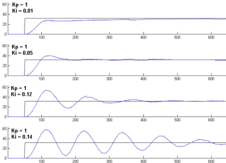
On voit cette fois-ci que le terme intégral a bien fonctionné et que l'erreur statique est nulle. On constate aussi que plus le gain  $K_i$  est grand, plus le système converge vite. En revanche, plus  $K_i$  est grand, plus le système oscille et plus le dépassement est grand. Sur des asservissements en position le terme dérivé permet de diminuer, le dépassement et les oscillations. Nous allons voir que dans notre cas, nous avons quelques problèmes.
