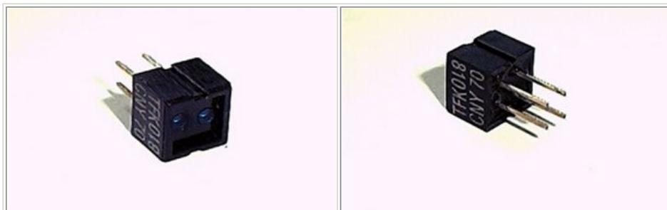
Le CNY70 est un composant spécialement créé pour ce genre de capteurs. Il comporte un émetteur et un récepteur infrarouge. L'émetteur et le récepteur sont accordés sur la même longueur d'onde. L'émetteur est une diode infrarouge centrée sur la longueur d'onde 950 nm. Le récepteur est un phototransistor. Voici l'implantation d'un CNY70 :
